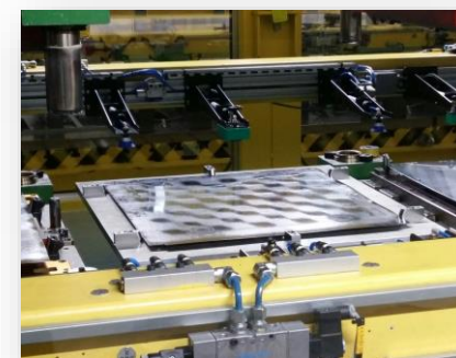
Lubrificazione settoriale in quadrati 50x50 mm
